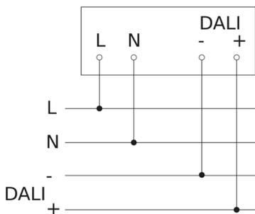
Schema elettrico collegamento in rete di DALI-2 APC & DALI-2 IPD
